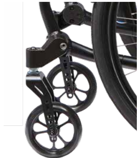
Extrem stabile Lenkradaufnahme, daher sehr gut geeignet für Zusatzantriebe
